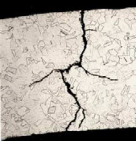
Spänningskorrosionsspricka som har fullständigt penetrerat väggen av ett rör i stålsort SS-EN 1.4307 som exponerats till vätska innehållande klorider i en värmeväxlare.
