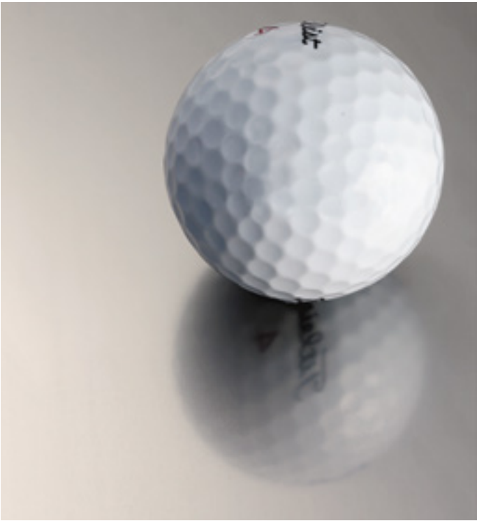
2B: kallvalsat, glödgat, betat med slutlig lätt kallvalsning.
